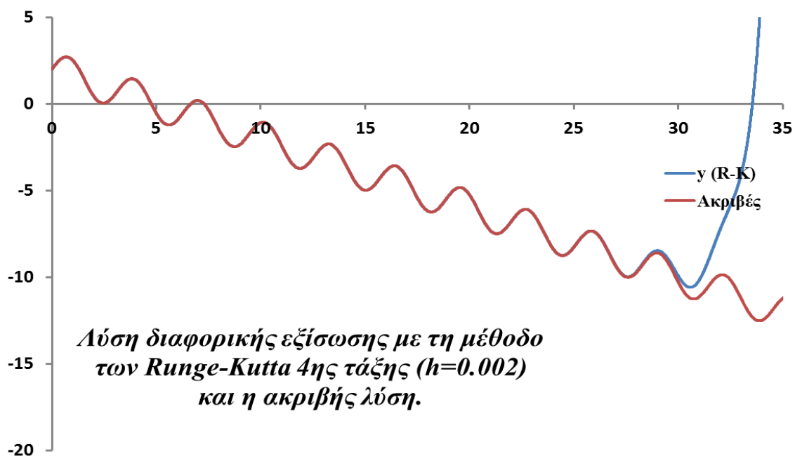
Σχήμα 9.14 Αριθμητική (μπλε) και ακριβής (κόκκινη) λύση της διαφορικής εξίσωσης με βήμα ολοκλήρωσης h=0.002
