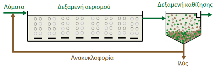
(α) Κλασικό σύστημα (αερισμός ομοιόμορφος σε όλο το μήκος της δεξαμενής)
