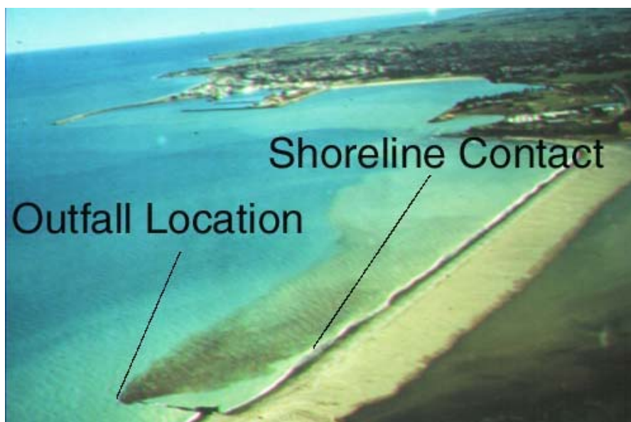
Παράδειγμα σημειακής υποεπιφανειακής απόρριψης άλμης από εγκατάσταση αφαλάτωσης σε κοντινή παραλία.
