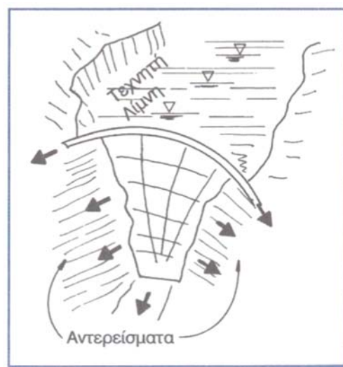
(β) τοξωτό φράγμα
