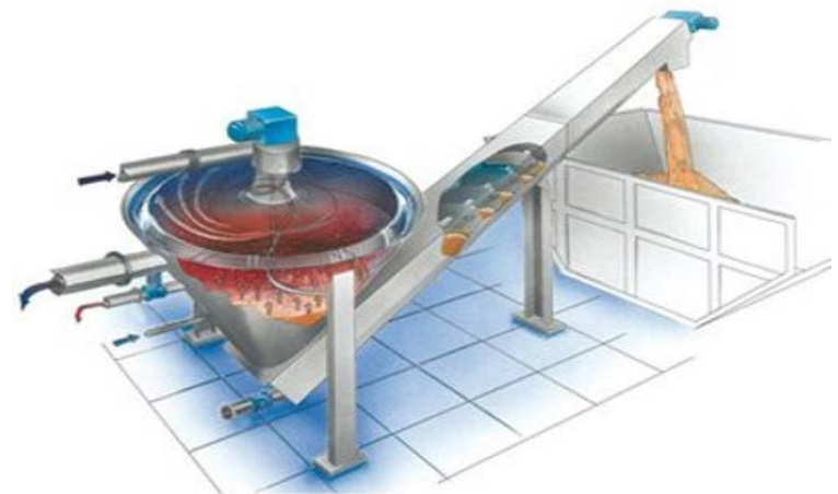
Κοχλιωτός διαχωριστής με ενσωματωμένο υδροκυκλώνα
