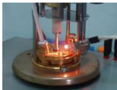
Εικόνα 4-1: Απεικόνιση της συσκευής Pensky-Martens κλειστού τύπου.
