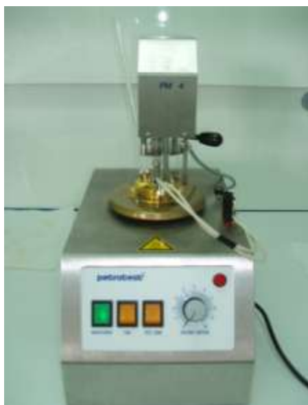
Εικόνα 4-1: Απεικόνιση της συσκευής Pensky-Martens κλειστού τύπου.
