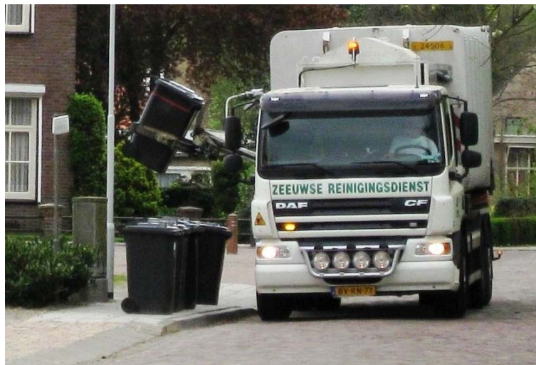
Εικόνα 2.14: Φόρτωση κάδου με απορριματοφόρο όχημα ημιαυτόματης συλλογής (πλευρικής φόρτωσης).
