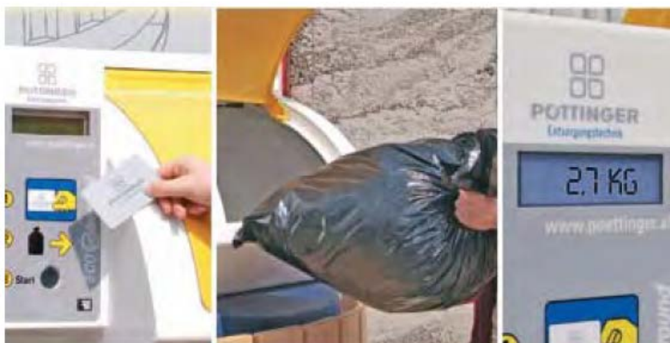
Εικόνα 2.9: Παραδείγματα κάδων με δυνατότητα αναγνώρισης του χρήστη [TEE, 2006].
