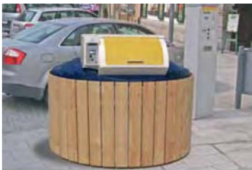
Εικόνα 2.8: Παραδείγματα κάδων με δυνατότητα ογκομέτρησης και/ή ζύγισης των απορριμμάτων [TEE, 2006].
