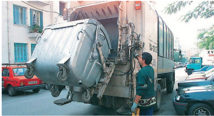
Εικόνα 2.13: Φόρτωση και εκκένωση κάδου με απορριματοφόρο όχημα χειρωνακτικής συλλογής (οπίσθιας φόρτωσης).
