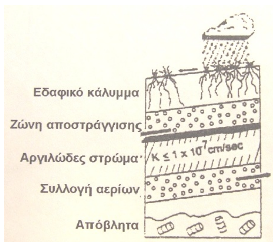
Σχήμα 7.4: Σχηματική απεικόνιση τελικής κάλυψης ενός XYT [Κομίλης, 2010].
