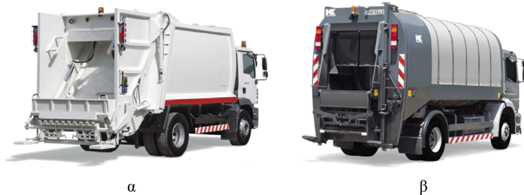
Εικόνα 2.16: Απορριματοφόρο όχημα με μηχανισμό συμπίεσης τύπου: α. πρέσας και β. μύλου.
