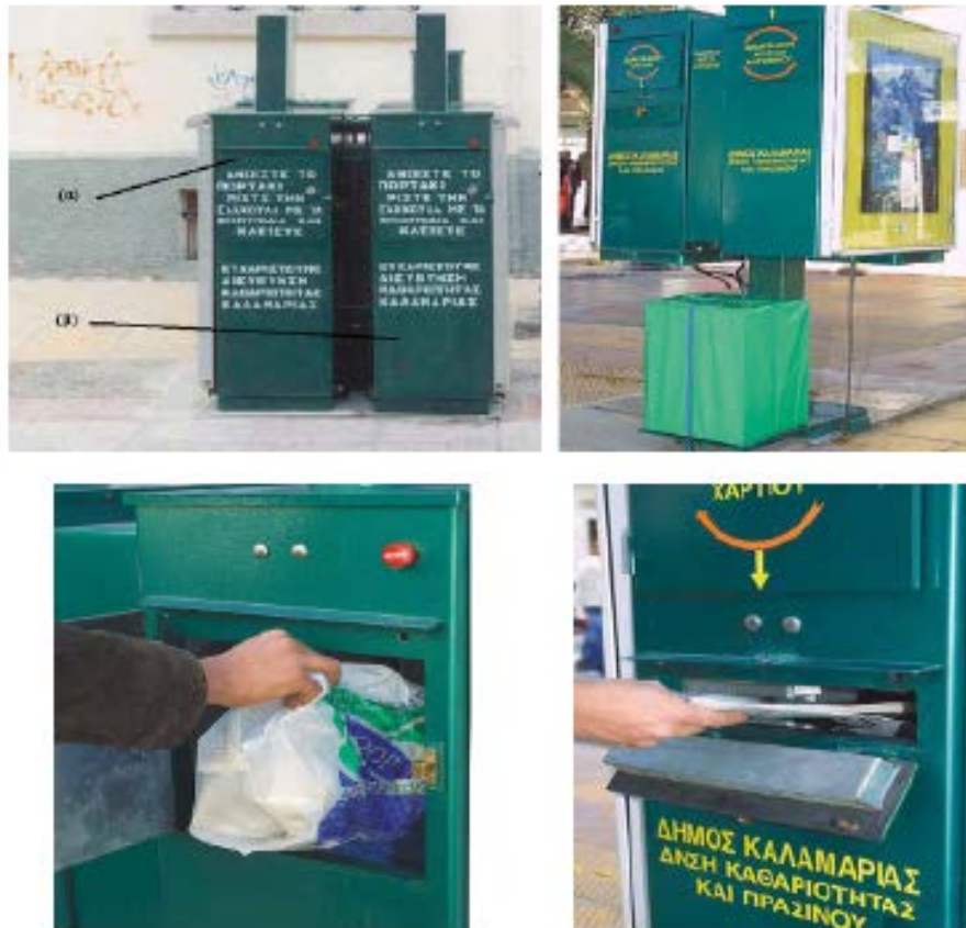
Εικόνα 2.11: Σύστημα προσωρινής αποθήκευσης με ενσωματωμένο θάλαμο συμπίεσης [ΤΕΕ, 2006].
