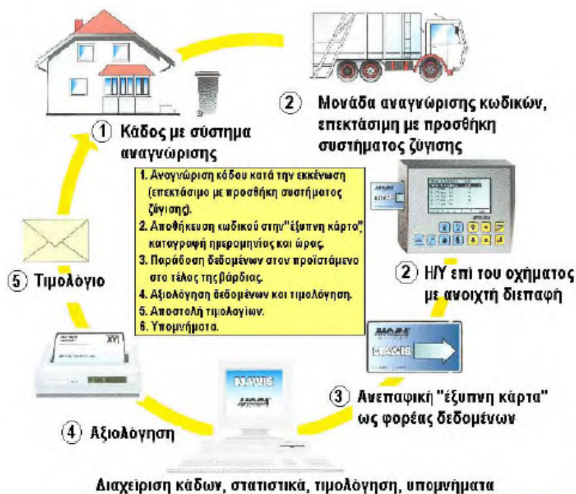
Εικόνα 2.10: Σχηματική απεικόνιση λειτουργίας αυτόματου συστήματος αναγνώρισης κάδων [TEE, 2006].
