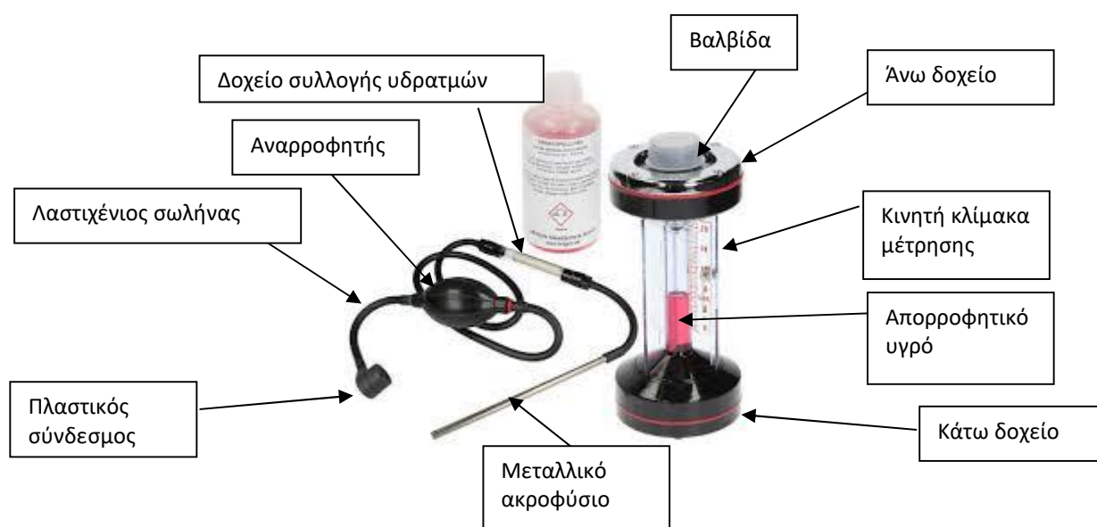
Εικόνα 3.2: Αναλυτής CO 2 FYRITE
