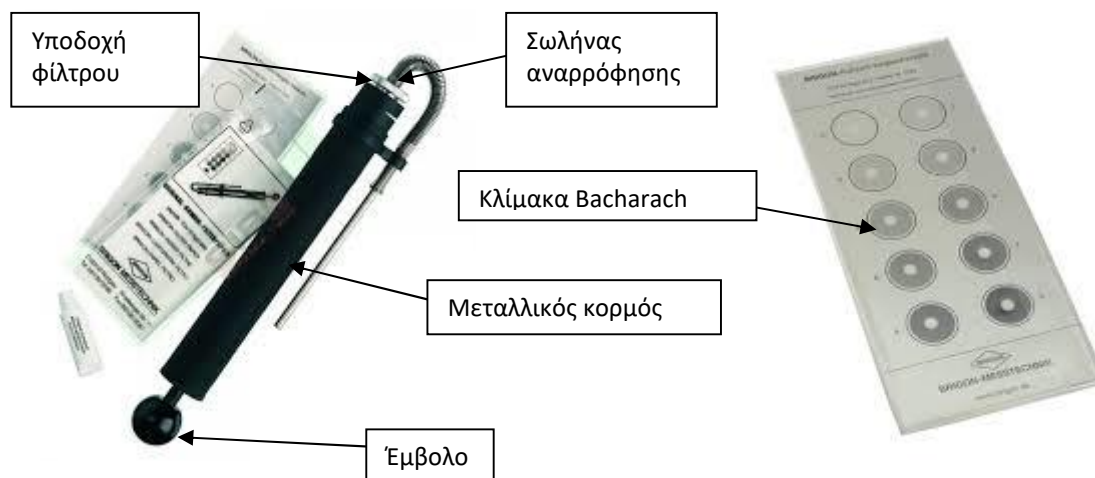
Εικόνα 3.4: Μετρητής αιθάλης Brigon και κλίμακα Bacharach
