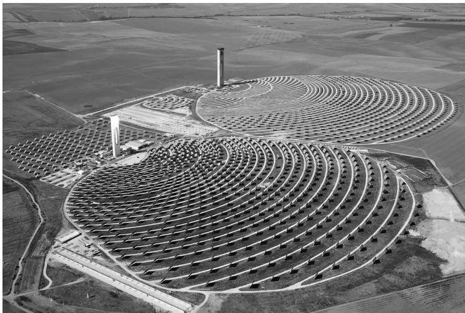
Εικόνα 3.4 Οι ηλιοθερμικοί σταθμοί ισχύος ηλιακού πύργου PS20 και PS10 (Ανδαλουσία, Ισπανία). (Πηγή: commons.wikimedia.org)
