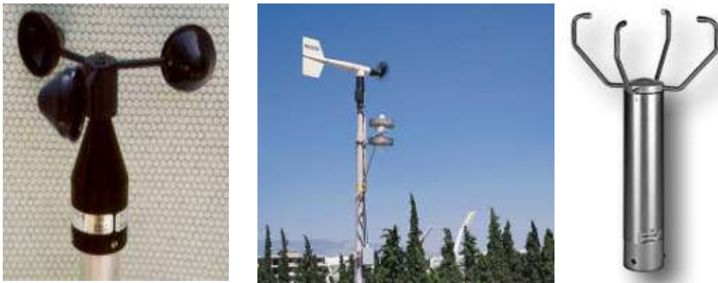
Σχήμα 6: Τύποι ανεμομέτρων. α) ανεμόμετρο κυπέλλων, β) ανεμόμετρο έλικας, γ) ηχητικό ανεμόμετρο.
