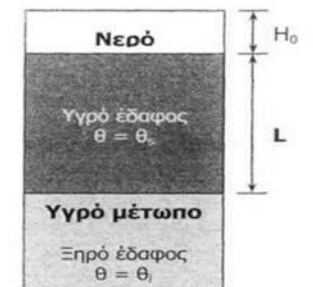
Σχήμα 4.3. Σκαρίφημα της θεωρίας του μοντέλου Green - Ampt
