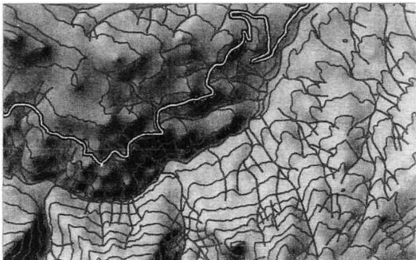
Σχήμα 5.1 Τρόπος χάραξης του υδρογραφικού δικτύου σε τοπογραφικό χάρτη.
