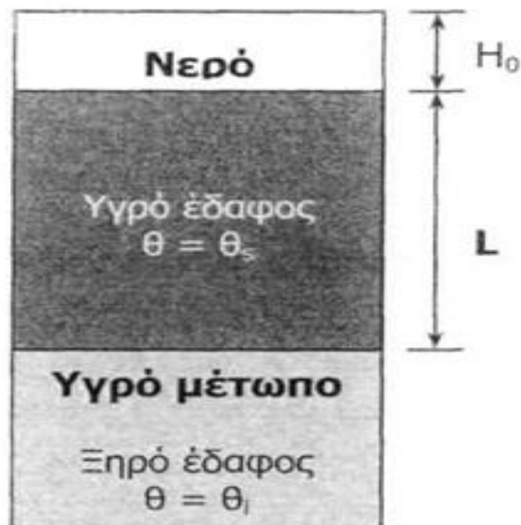
Σχήμα 4.3. Σκαρίφημα της θεωρίας του μοντέλου Green - Ampt
