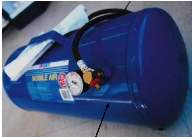
Δοχείο με περιεχόμενο υπό πίεση (ΦΩΤΟ: P.M. Anderson)
