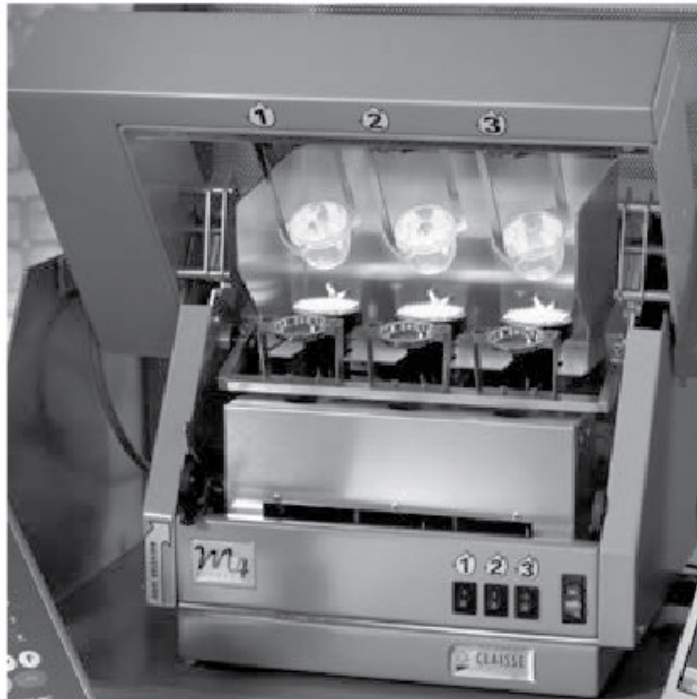
EIKONA 28-8 Αυτοματοποιημένη συσκευή, η οποία τήκει τρία δείγματα ταυτόχρονα με καυστήρες προπανίου. Τα χωνευτήρια Pt/Au περιστρέφονται ενώ είναι κεκλιμένα. [Ευγενική προσφορά Claisse, Κεμπέκ].
