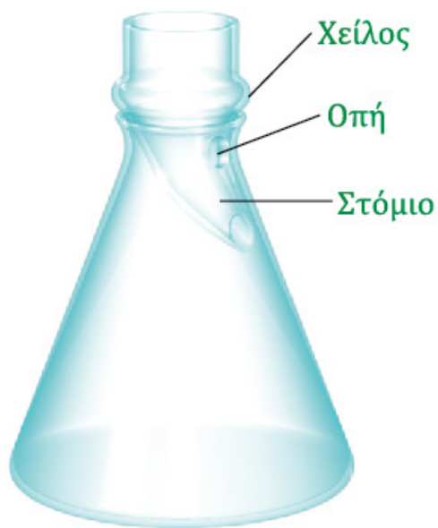
ΕΙΚΟΝΑ 28-11 Πώμα με αναρροή για υγρή αποτέφρωση σε φιάλη Erlenmeyer. Η οπή επιτρέπει στον ατμό να διαφύγει. Το κυρτό στόμιο αγγίζει το εσωτερικό της φιάλης. [Δεδομένα από D. D. Siemer and H. G. Brinkley, "Erlenmeyer Flask-Reflux Cap for Acid Sample Decomposition," Anal. Chem. 1981 , 53, 750].
