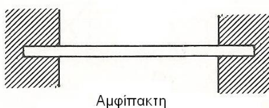
Εικόνα 3:Τυπική μορφή υπερστατικών δοκών – αμφίπακτη δοκός.
