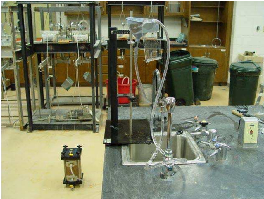
Εικόνα 6.2 Εργαστηριακή διάταξη διαπερατόμετρου σταθερού φορτίου
