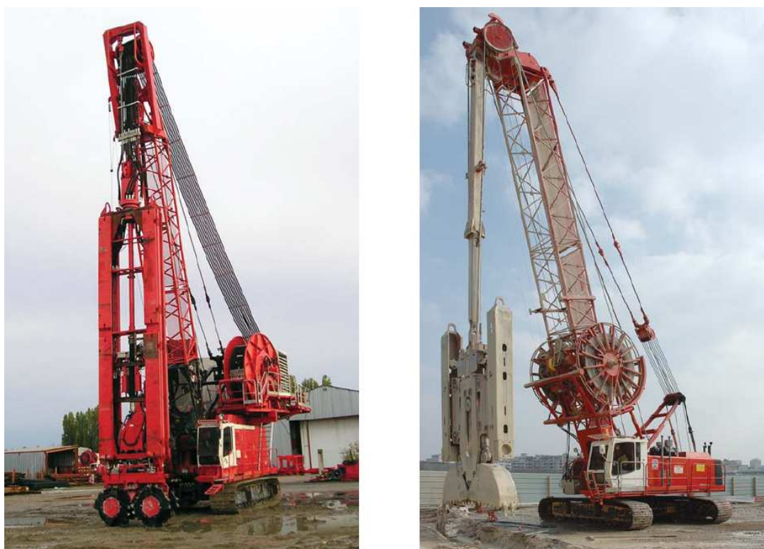
Εικόνα 8.3 Υδροφρέζα για σκληρά και βραχώδη εδάφη και διαφραγματική αρπάγη
