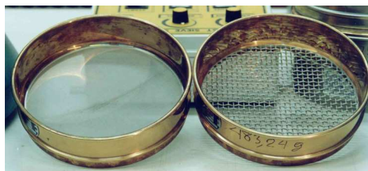
Εικόνα 6.1 Διάταξη κοκκομετρικής δοκιμής και πρότυπα κόσκινα
