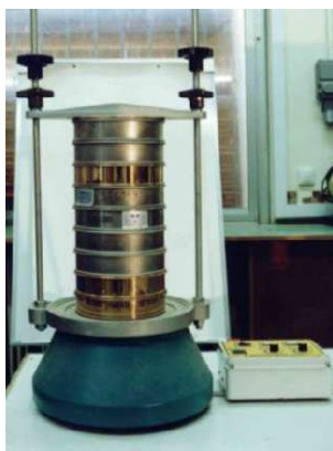
Εικόνα 6.1 Διάταξη κοκκομετρικής δοκιμής και πρότυπα κόσκινα
